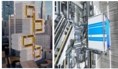
Gambar 6. 12. Lift Magnetik dengan Pergerakan Vertikal-Horisontal
