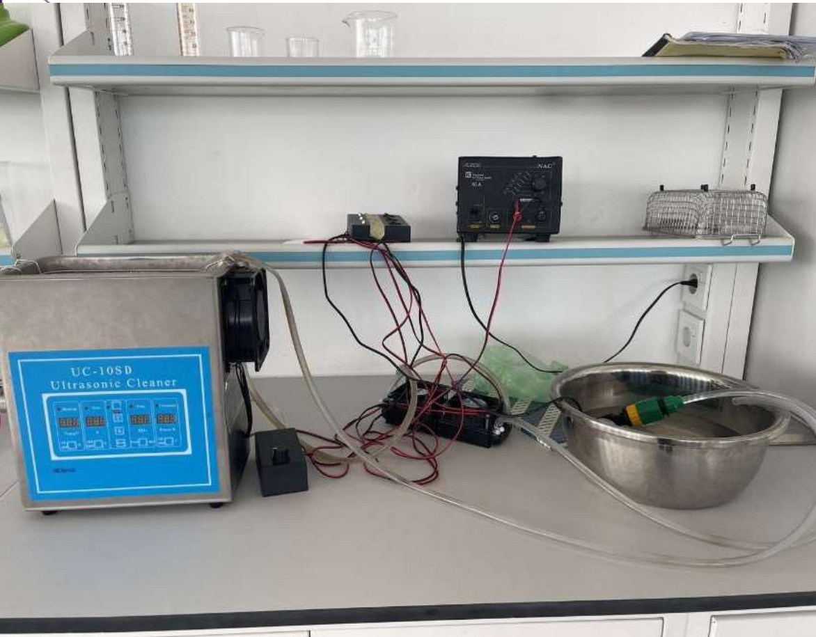
Gambar 5. Alat UAE yang dimodifikasi dengan tambahan kipas dan pompa
